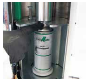
Dose und aufgesetzten Zylinder ganz nach Hinten drücken
