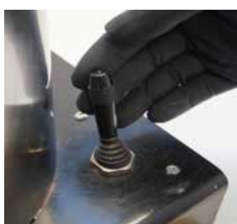
Hebel nach vorne ziehen. Die Farbe wird in die Dose gedrückt
