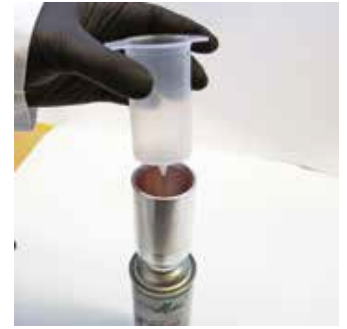
CleanJector in den Zylinder stecken
