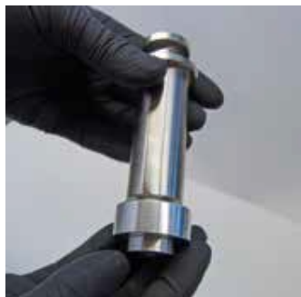
Ggf. den Teflonkolben Gegen den Metallkolben austauschen
